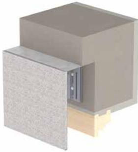
Wärmedämmverbundsystem Typ 1
